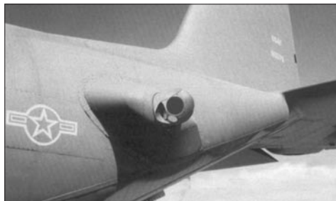
Гиростабилизированный блок подсистемы постановки активных помех СИЗ «Немезис», установленный на самолете ССО ВВС США AC-130U «Спуки»
